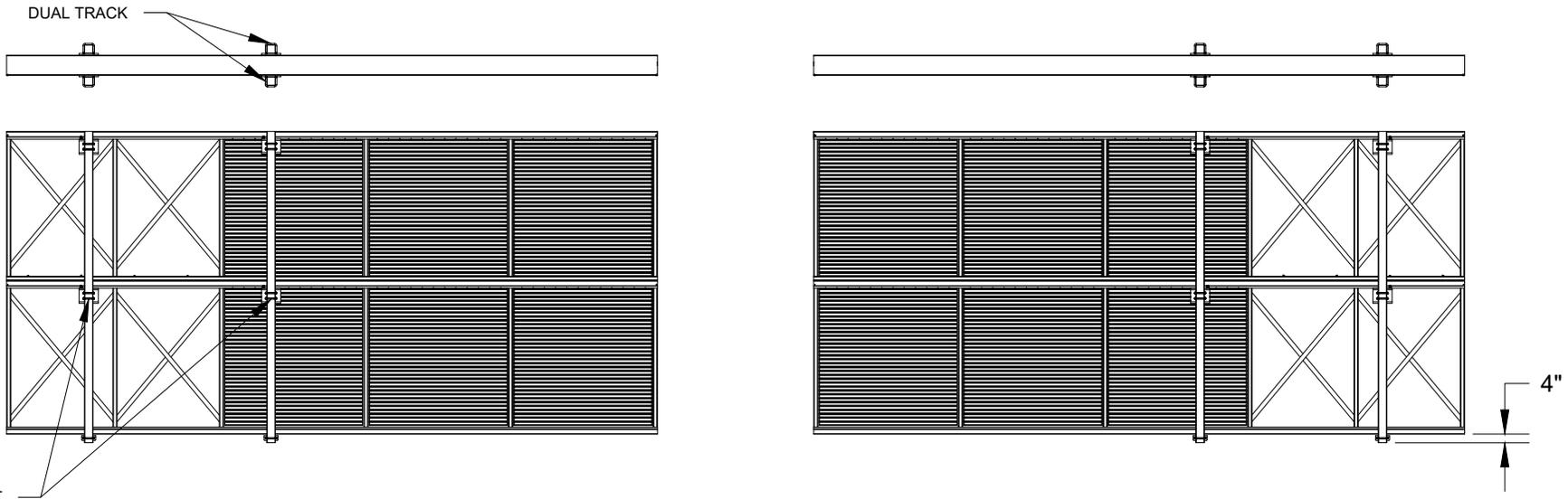
CANTILEVER SLIDE GATE OVER 360" OPENING
